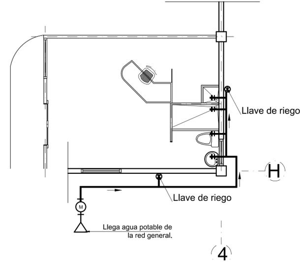
PLANTA DE OBRA MECANICA. AGUA POTABLE ESCALA 1:50
