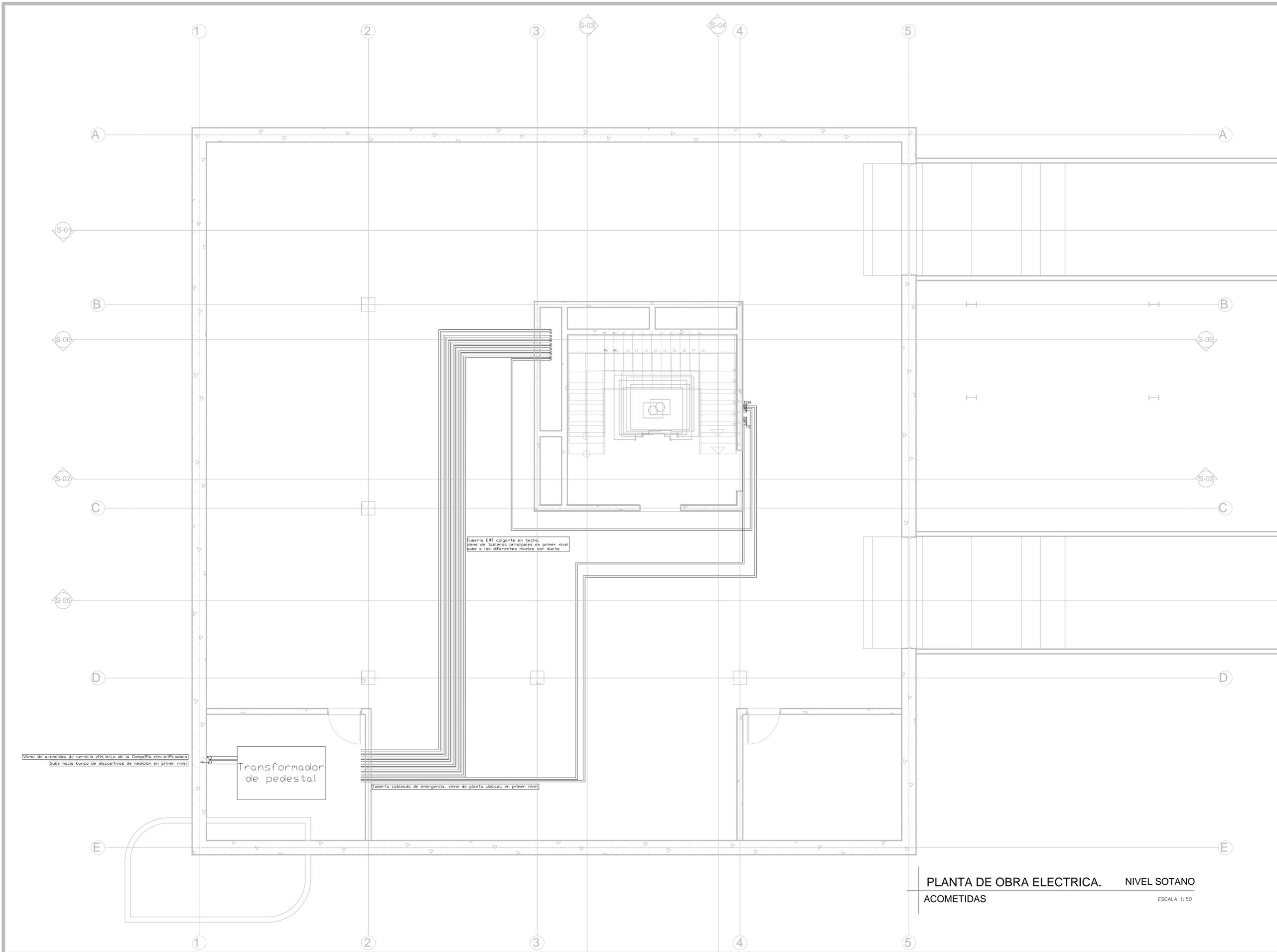
Tubería EMT colgante en techo, viene de tableros principales en primer nivel sube a los diferentes niveles por ducto
